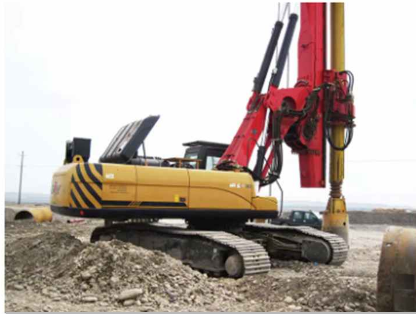
旋挖钻机 Rotary Drill Rig
