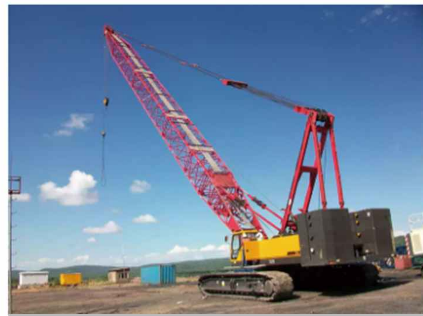
履带吊机 Crawler Crane
